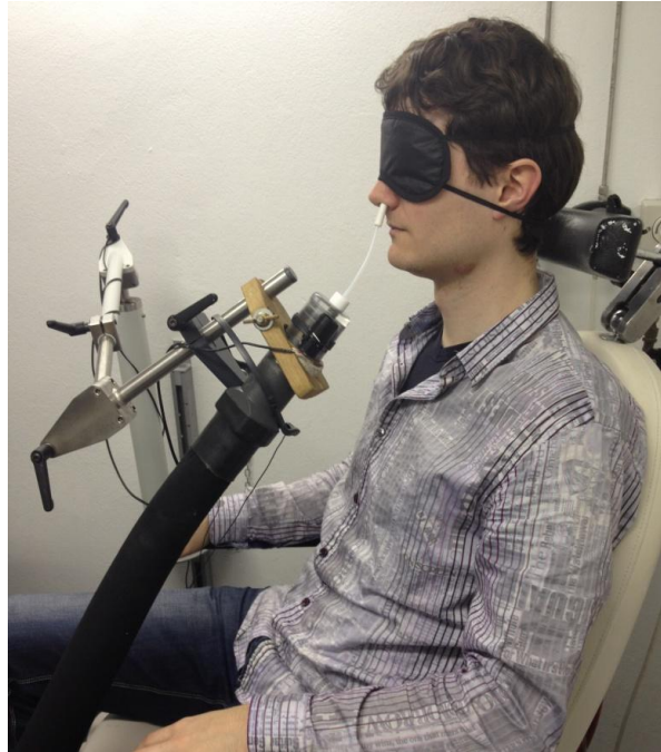
Abbildung 19 – Der Beispielproband während der olfaktometrischen Messung. Durch das im linken Nasenloch platzierte Riechstück wird das CO 2 -haltige Gasmisch in die Nasenhöhle geleitet.
