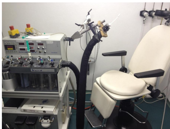
Abbildung 7 zeigt das Olfaktometer OM/2 der Firma Burghart Messtechnik, Wedel, Deutschland, an dem die olfaktometrischen Messungen der vorliegenden Studie durchgeführt wurden.
