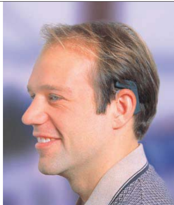
Nur ein Teil des Cochlea-Implantats (CI) ist bei einem CI-Träger zu sehen. Hinter bzw. auf dem Ohr sitzt der Sprachprozessor mit eingebautem Mikrophon.
