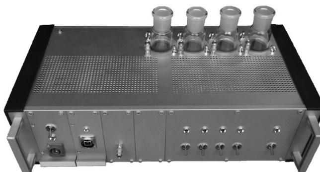
**Abbildung 7:** Frontaldarstellung des mobilen Olfaktometers. Quelle: Sommer et al., 2012, S. 190.
