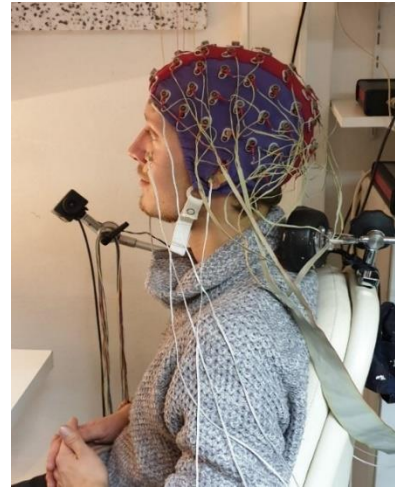
Abbildung 9: Proband kurz vor Beginn der EEG-Aufnahmen. Er trägt eine medium/large EEG-Haube mit 64 Elektroden, außerdem acht externe Elektroden.
