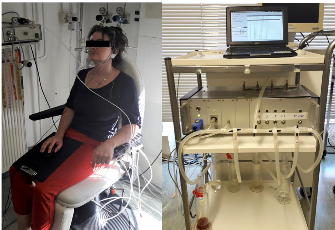
Abbildung 8: Das Olfaktometer. Eine Probandin mit Nasenbrille zur Geruchsdarbietung (links), Kopfhörern (Stimulus 1 und Stimulus 2) und einer Maus in der rechten Hand. Das Olfaktometer OM4 (Burghart, Wedel, Deutschland), über welches die Geruchsdarbietung gesteuert wird (rechts). Die fünf Gerüche sind zur Verblindung des Probanden mit Buchstaben gekennzeichnet (A = Orange, B = Pfefferminze, C = Moschus, D = Vanille und E = Luft).
