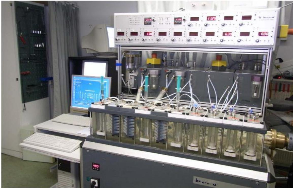
Abbildung 7: Das für die experimentelle Durchführung zum Einsatz gekommene Olfaktometer der Baureihe OM6b (Burghart, Wedel, Deutschland)
