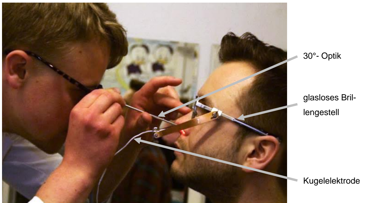
Abbildung 4: Versuchsaufbau: Kontrolle der Kugelelektrodenlage mithilfe einer 30°-Optik an einem Probanden mit glaslosem Brillengestell
