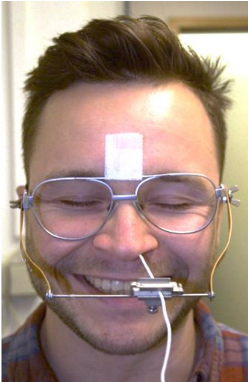
Abbildung 5: Versuchsaufbau: Proband mit fixierter Kugelelektrode
