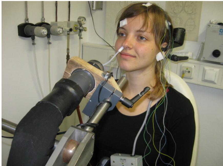
**Abbildung 18: Vorbereitung der Messung:** Die Elektroden werden nach dem 10/20 System auf dem Kopf befestigt. Das Nasenstück des Olfaktometerausganges befindet sich im rechten Nasenvorhof.
