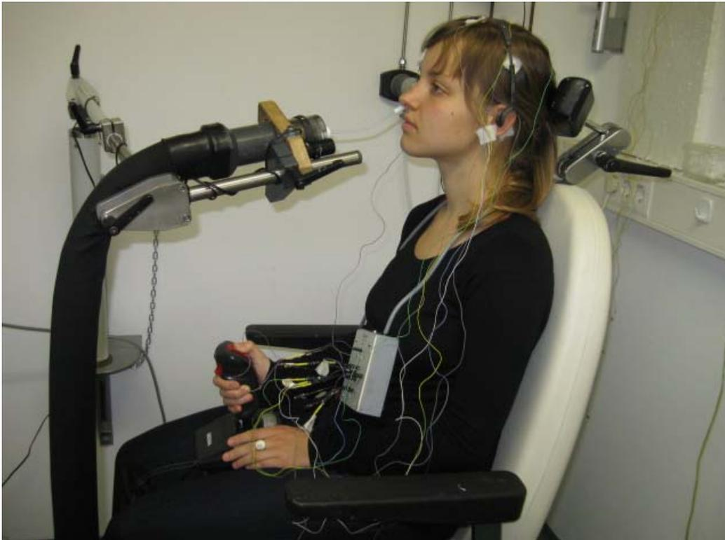
**Abbildung 19: Probandin während der Messung:** Das Olfaktometer wird in Betrieb gesetzt und der Probandin mit Duftstoff angereicherte Luft zugeführt. Über die Kopfhörer wird das Rauschen eingespielt, um Ablenkung durch akustische Reize zu vermeiden. Die Probandin spielt das Computerspiel.
