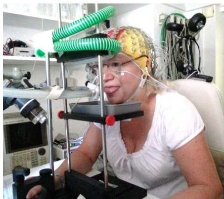
Abbildung 5 Position der Probanden während der Messung. Die Zungenspitze der Probanden bleibt während der gesamten Aufzeichnung etwa 5 cm vor dem Auslass des Gustometers. Die Applikation der Stimuli erfolgt mit einem Druck von 0,5 bar.
