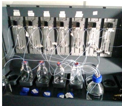
Abbildung 3 Das Gustometer mit den fünf vorbereiteten Schmecklösungen: salzig, sauer, süß, bitter und umami. Ein künstlicher Speichel (Aqua ad injectabilia) wurde genutzt, um die Zunge zu spülen und anzufeuchten.
