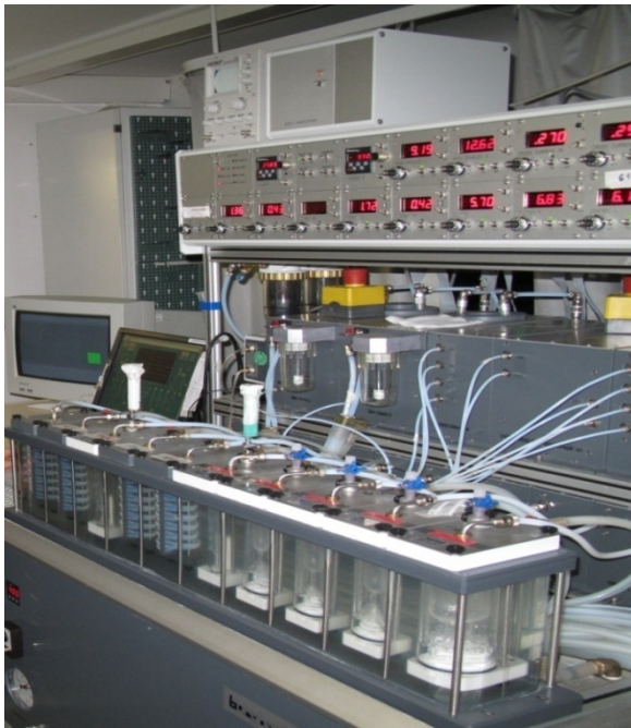
Abbildung 12.: Olfaktometer mit seinen Bestandteilen
