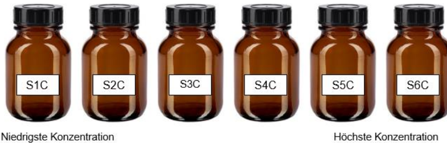
Abbildung 1: Verdünnungsreihen der Messreihen A (Lösungsmittel: Wasser-Ethanol-Gemisch) und B (Lösungsmittel: 0,9 \mu molare Capsaicin-Lösung (C)) am Beispiel Saccharose (S).
