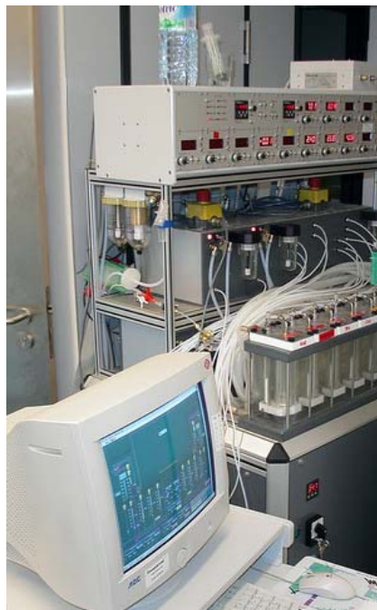
Abbildung 2 Olfaktometer OM6b mit angeschlossener PC-Steuerungseinheit
