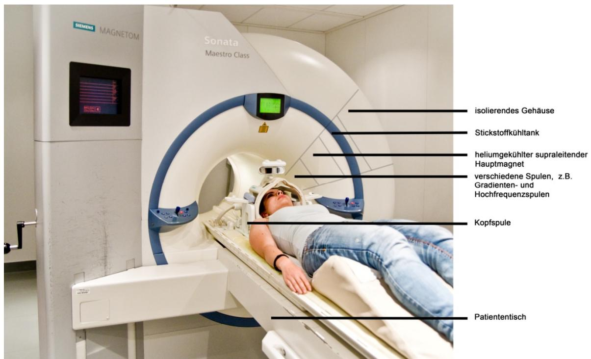
**Abbildung 7: Aufbau Magnetresonanztomograph (modifiziert nach (Kauffmann et al., 2001))**
