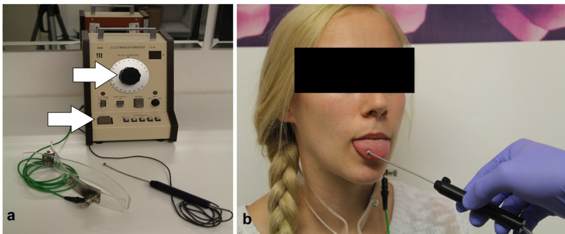
Abbildung 4: Elektrogustometer RION TR-06 und dessen Anwendung.
