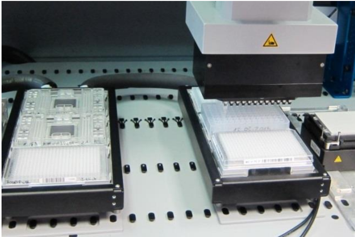
Abb. 5: Automatisierte Beladung der Fluidigm Chips. Die Abbildung zeigt die komplett automatisierte Überführung der Probanden-DNA, der Primer, des PCR-Mixes und der Harvest Solution auf die Access Array Chips (Mit freundlicher Genehmigung der DKMS Life Science Lab GmbH)
