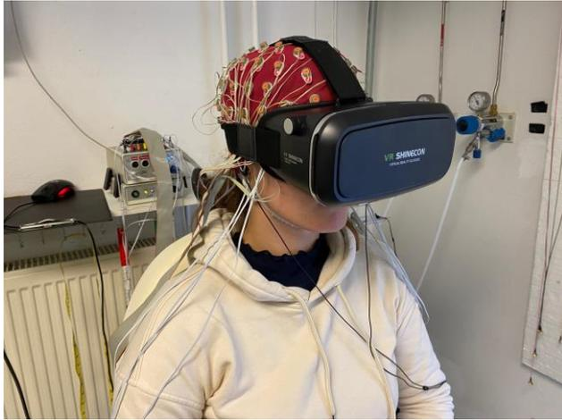
Abbildung 6: Probandin mit angebrachten 64-Kanal-EEG, VR-Brille, sowie Kopfhörer auf dem Versuchsstuhl.
