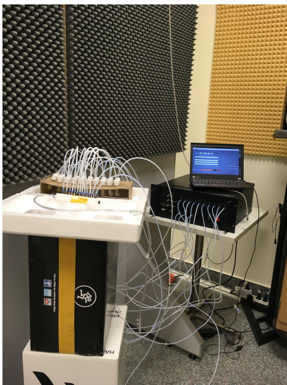
Abbildung 17: Foto des Geruchs-Präsentationssettings. Hinten rechts das Olfaktometer (schwarzer Kasten), darauf der Laptop mit laufender Steuerungssoftware. Vorne links die Halterung für die Geruchsröhrchen und der Mischkopf.
