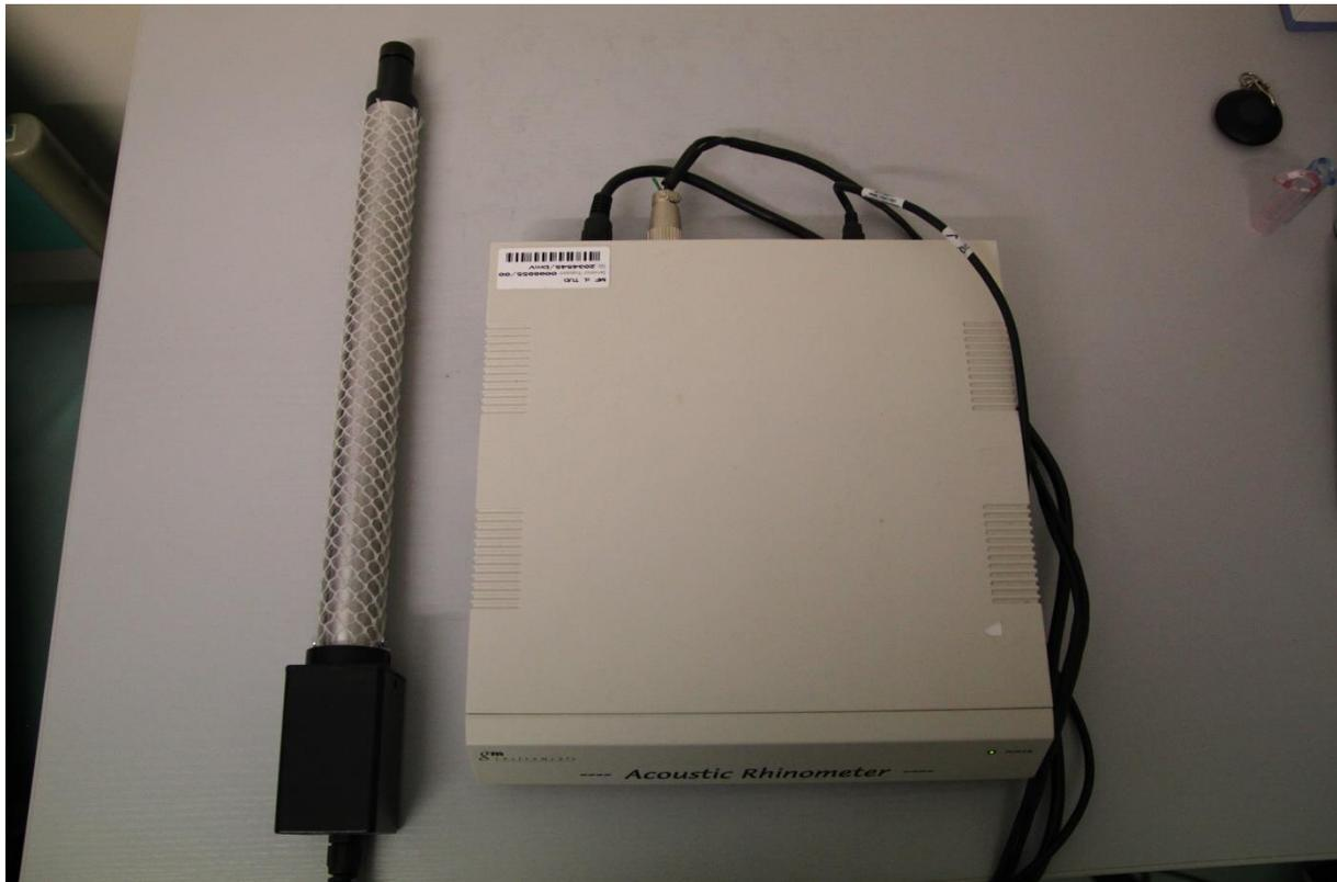
Abbildung 7: Aufbau des Acoustic Rhinometers.
