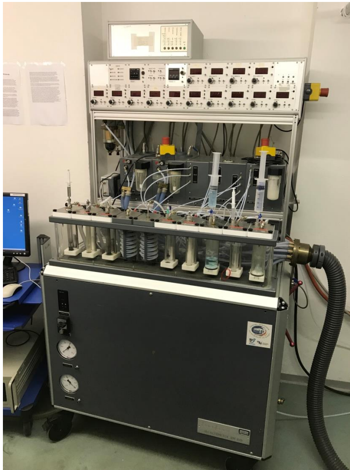
Abb. 12 Olfaktometer Modell OM6b der Firma Burghart im Interdisziplinären Zentrum für Riechen und Schmecken der Universitäts-HNO-Klinik der Technischen Universität Dresden
